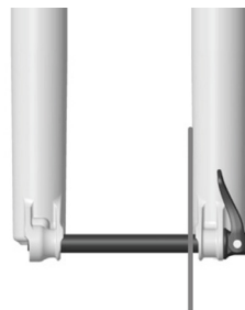
PERNO INSTALLATO CORRETTAMENTE
