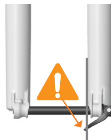
PERNO INSTALLATO IN MODO ERRATO
