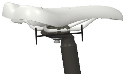
GERADER ABSCHNITT DER SATTELSTREBEN
